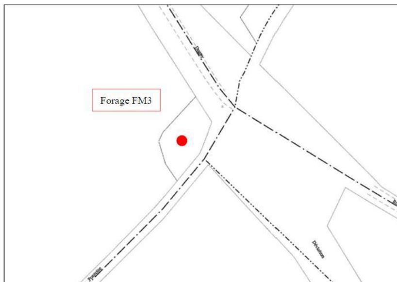
Le forage FM3 a été réalisé du 7 novembre 2012 au 25 avril 2013 par la Société Forages MASSE (17). Il est profond de 94 m et capte la nappe de l'Yprésien. Les travaux réalisés ont consisté à :
